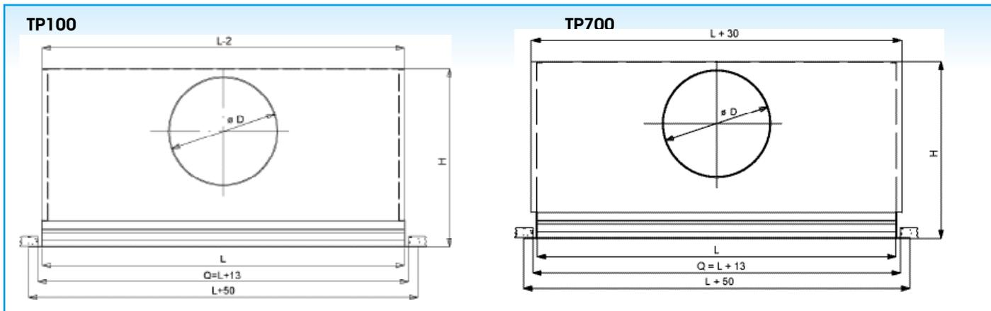
H = 325mm (si TE600 monté avec TP100)
