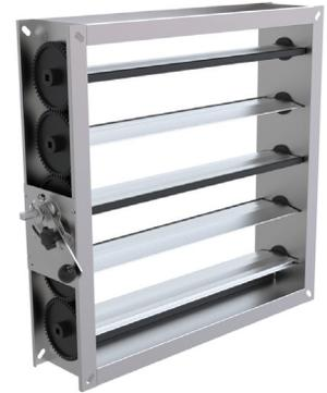
Registre galvanisé avec des volets en aluminium à mouvement contre-rotatif. Les volets en aluminium sont prévus d'un bourrelet et un roulement avec peu d'entretien. Enveloppe selon EN1751, classe C les volets selon EN1751, classe 2/4.
