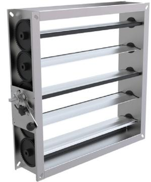
Jalousieklappe mit einem Gehäuse aus galvanisiertem Stahl und gegenläufigen Lamellen aus Aluminium. Diese Klappen sind von einer Dichtung und von wartungsfreien Lagern versehen. Gehäuse Leckluftstrom nach EN1751 Klasse C, Klappen nach EN1751 Klasse 2/4.
